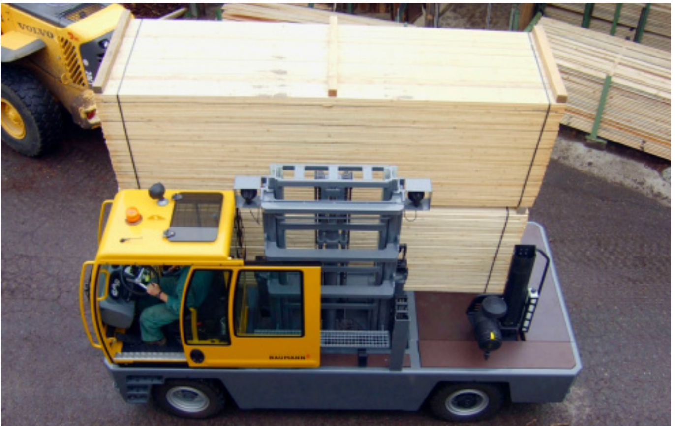
Seitenstapler der GX-Baureihe mit einer Tragfähigkeit von 5 bis 7,5 t, ausgerüstet mit der neuen Kabine beim Einsatz in der Holzindustrie. (Bilder: Baumann)
